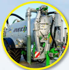
Gelenkiger Ansaugarm mit Turbo 8"
